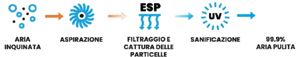
Precipitatore elettrostatico (ESP)
